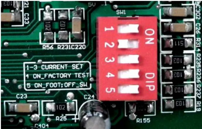
1-3 CURRENT SET: Es ajustado de fábrica, no se pueden cambiar. Si se cambian, el soldador puede romperse.
